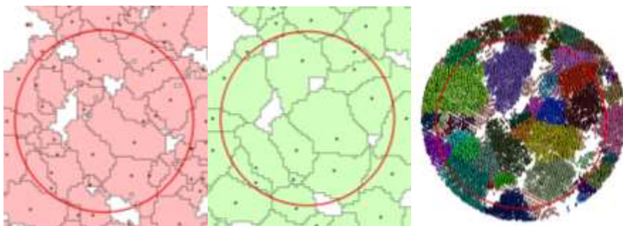
Représentation des 2 méthodes de segmentations du nuage de points Lidar abordées dans cette étude. La première image (à gauche) montre la segmentation Bassin-Versant sans lissage préalable du Modèle Numérique de Hauteur (MNH) Lidar, la deuxième la segmentation Bassin-Versant avec lissage du MNH et la dernière la segmentation PTree de Véga et al. 2014 ( Int. J. Appl. Earth Obs. Geoinf. 33 : 98-108).
