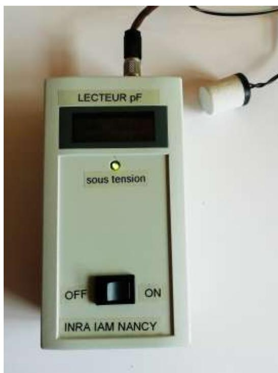
Prototype de lecteur pF développé dans le cadre du projet LowCostLogger (A) et prototype de pré-commercialisation (B) développé par la startup WETRUF dans le cadre de la licence de savoir faire INRAE/WETRUF
