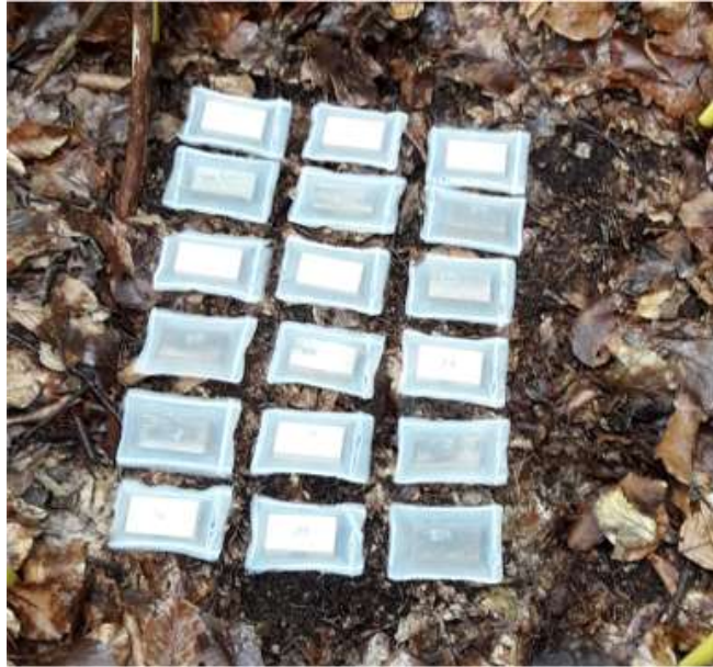
Dispositif d'incubation in situ de bûchettes de hêtre à différents stades de pré-dégradation causée in vitro par Gloeophyllum trabeum .
